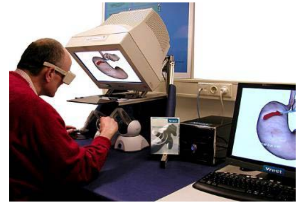
Abbildung 4 Dr. Bob Geelkerken kalibriert das haptische Feedback, das mit dem Abtasten des Bauches eines virtuellen Patienten zusammenhängt
